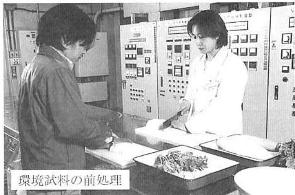
に係る調査研究を行っています。環境試料の採取では、採取計画を立案し、現地で採取します。分析試料の調製及び前処理では、年間約2800試料について、分析や測定に適した形態に、しかも試料の代表性や目的核種を損なうことなくkg単位の環境試料をg単位にまで減容しています。放射能分析確認調査で使用する分析比較試料の調製では、既知量の放射能を添加した模擬試料及び放射能を添加しない土壤や生物灰の試料を調製しています。
