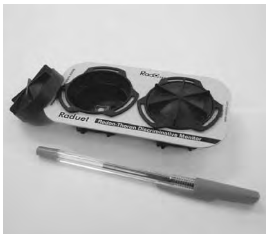
図4.1 パッシブ型ラドン測定器
