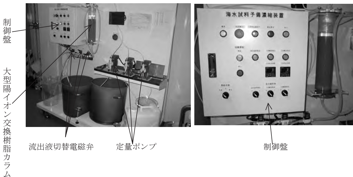
図2.1 海水試料予備濃縮装置の構成
