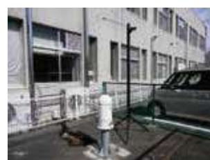
NaI 検出器へのガンマ線源照射
