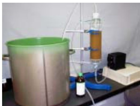
海水試料の前処理濃縮操作（イオン交換法）
