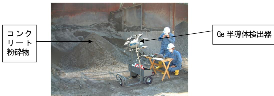
図 13.1 Ge 半導体検出器を用いた現場での測定
