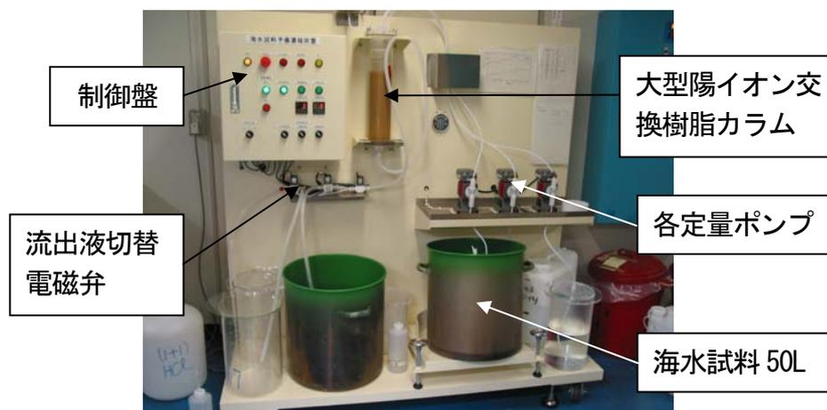
図 1.1 海水試料予備濃縮装置（原型機）の構成
