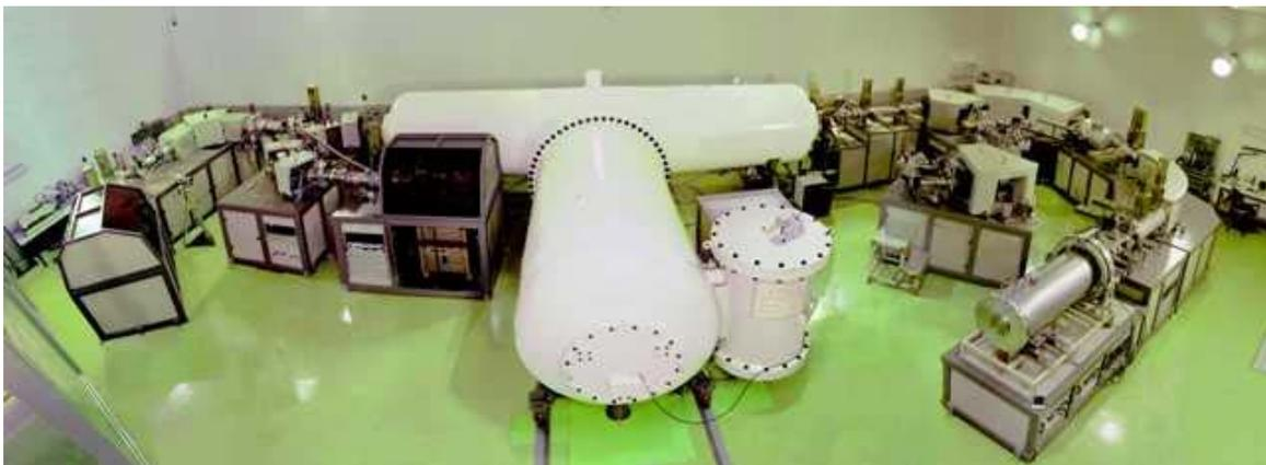
本装置は、イオン源、イオン入射部、タンデム型加速器部、高エネルギーイオン質量分析部で構成される。
