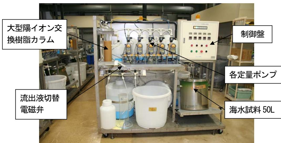
図 1.3 海水試料予備濃縮装置（実用機）の構成
