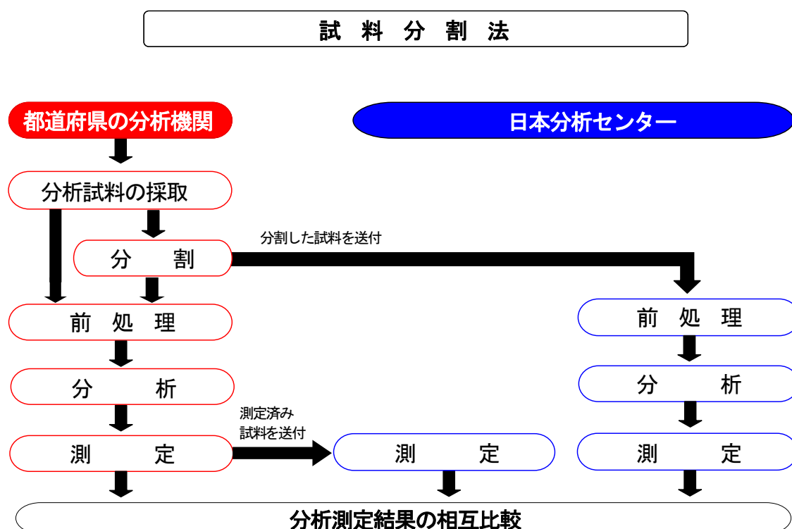
図 2.1 試料分割法による放射能分析確認調査
