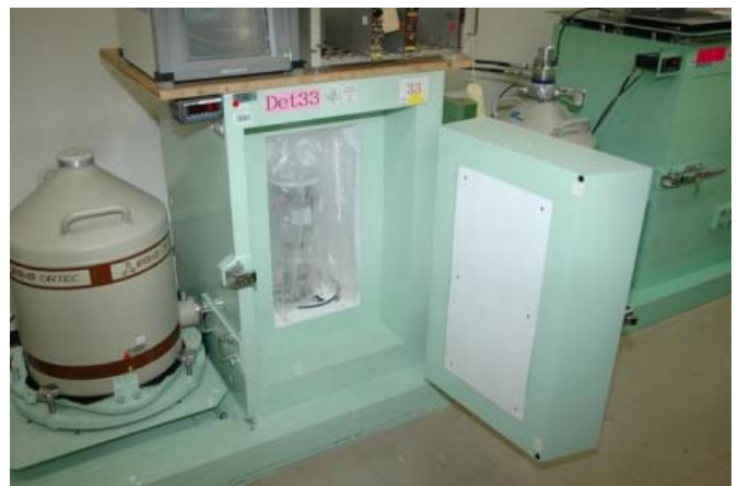
Ge半導体検出器による試料の測定の様子
