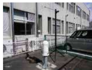
NaI 検出器へのガンマ線源照射
